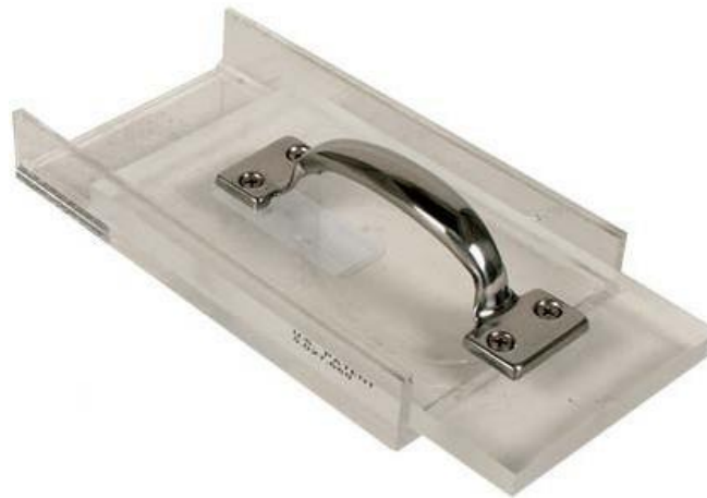
Figura 126 - 1. Aparato de enrollamiento para determinar el límite plástico
